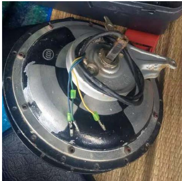
Figura 2 – Retirada do motor 36v da roda traseira
