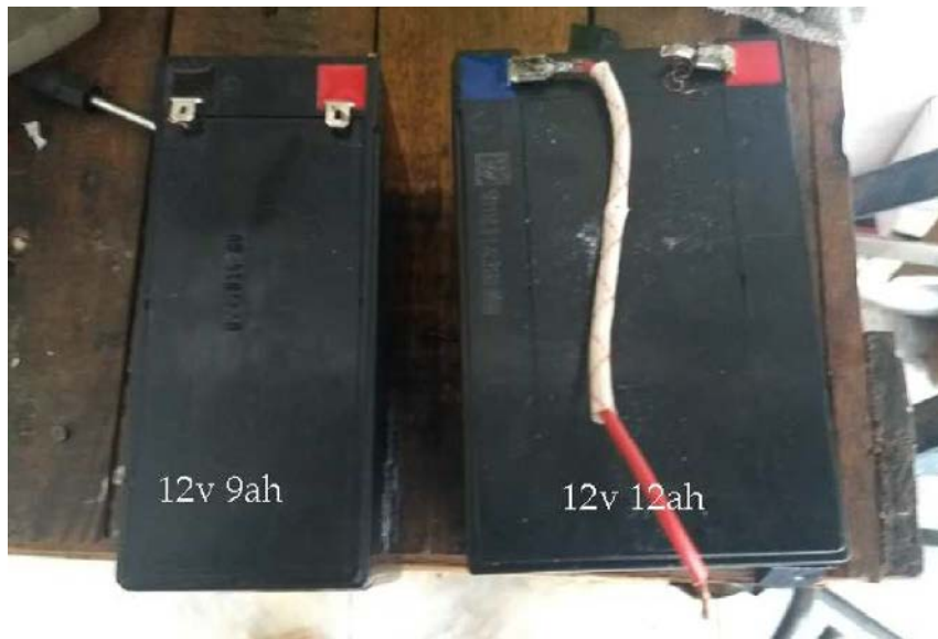
Figura 5 – Baterias de chumbo ácido 12-9ah (lado esquerdo) e 12v-12ah (lado direito)
